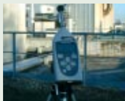
Station de mesure de bruit.
